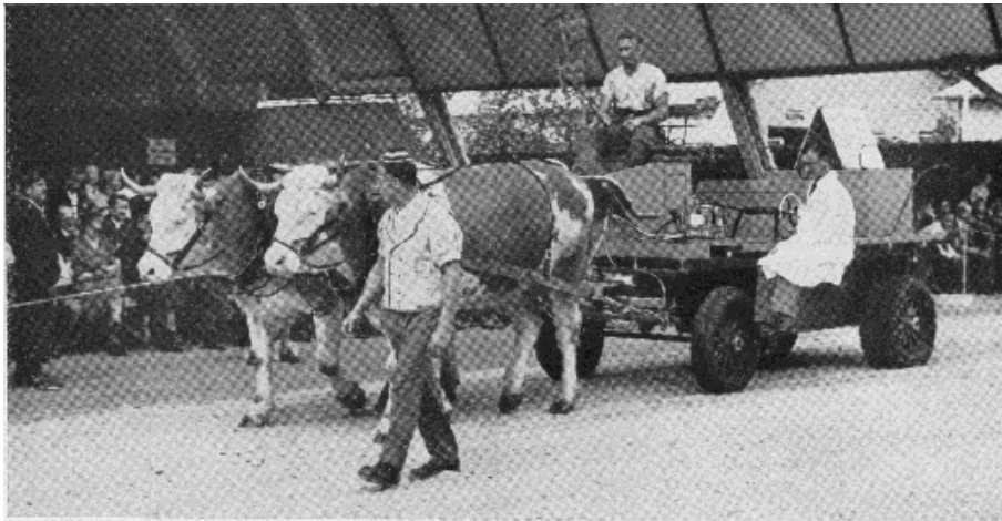
Rinderleistungsschau. Simmentaler Fleckvieh am Zugkraftmesswagen der E.T.H. Vaches simmentaloises attelées à la voiture pour le mesurage de la force de traction.
