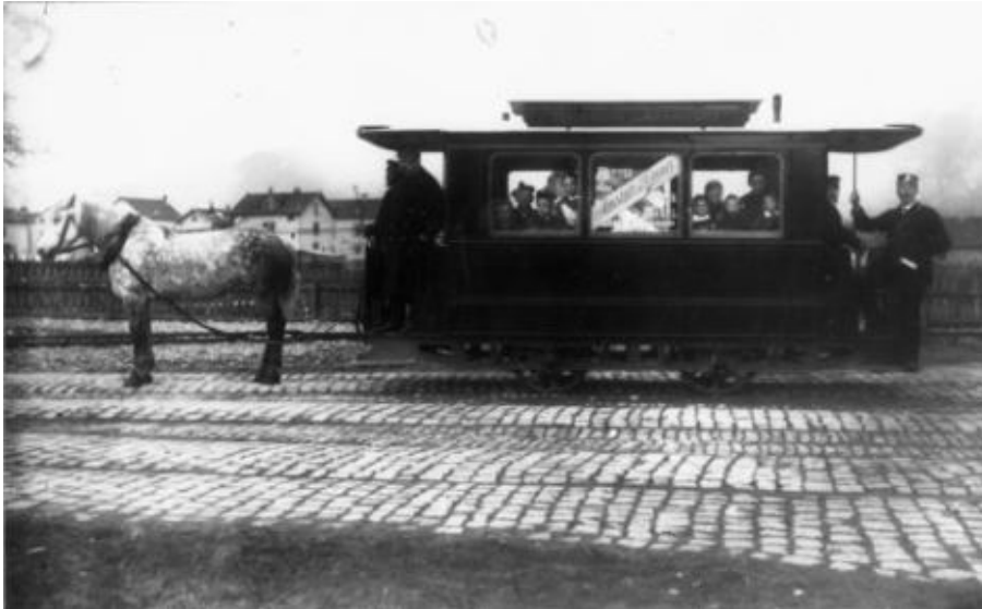
Pferdetram in der Zürcher Vorortsgemeinde Aussen Sihl im Jahr 1890. Die Wagen hatten keine Deichsel, und das Geschirr der Pferde wies kein Rückhaltegeschirr auf. Das heisst, dass die Tiere während der Fahrt keine permanente Möglichkeit der Kontrolle über die Zuglast hatten. (Amt für Städtebau Stadt Zürich, Baugeschichtliches Archiv, PK_0526)
